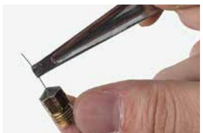
1 本体とフェューエルラインを分解してから、先端のジェットを付属品のジェット&ケーブルツールで緩めます。最後は指で回してジェットを外します。
