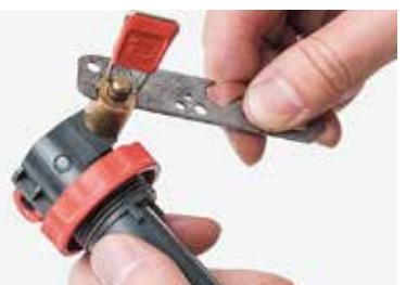
1 ポンププランジャーを外します。手順は矢印1の先端を写真の位置に合わせ、動かさないようにして矢印2の方向へ回転させます。プランジャーの固定が解除されたら、矢印3の方向へ抜きます。
