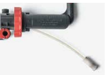
4 取り外したコントロールバルブの付け根にあるOリングの劣化状態を調べます。交換する場合は安全ピンの先に引っかけて取り外してください。安全ピンの先端をペンチで曲げると効率的です。
